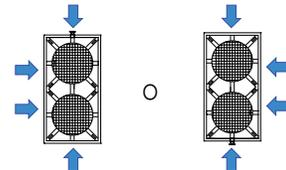
**Módulo T2 con 2 entradas de aire:** en los dos lados cortos de la unidad. (orientación -L).
