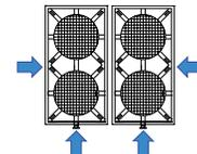
**Módulo T2 con 2 entradas de aire:** Disposición cuadrada de cuatro módulos con entradas de aire por un lado largo y un lado corto por módulo (orientación -X).
